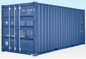
Container sind nach ISO 668 normiert, haben eine Breite von 8 Fuss und sind entweder 20 Fuss (Twenty-foot Equivalent Unit, TEU) oder 40 Fuss (Forty-foot Equivalent Unit, FEU) lang. Masse 20-Fuss-Container: Innenmasse  $5,89 \times 2,35 \times 2,39$  m; Volumen rund  $33 \text{ m}^3$ ; Ladegewicht 24 t. Masse 40-Fuss-Container: Innenmasse  $12,02 \times 2,35 \times 2,39$  m; Volumen rund  $68 \text{ m}^3$ ; Ladegewicht 30 t.
